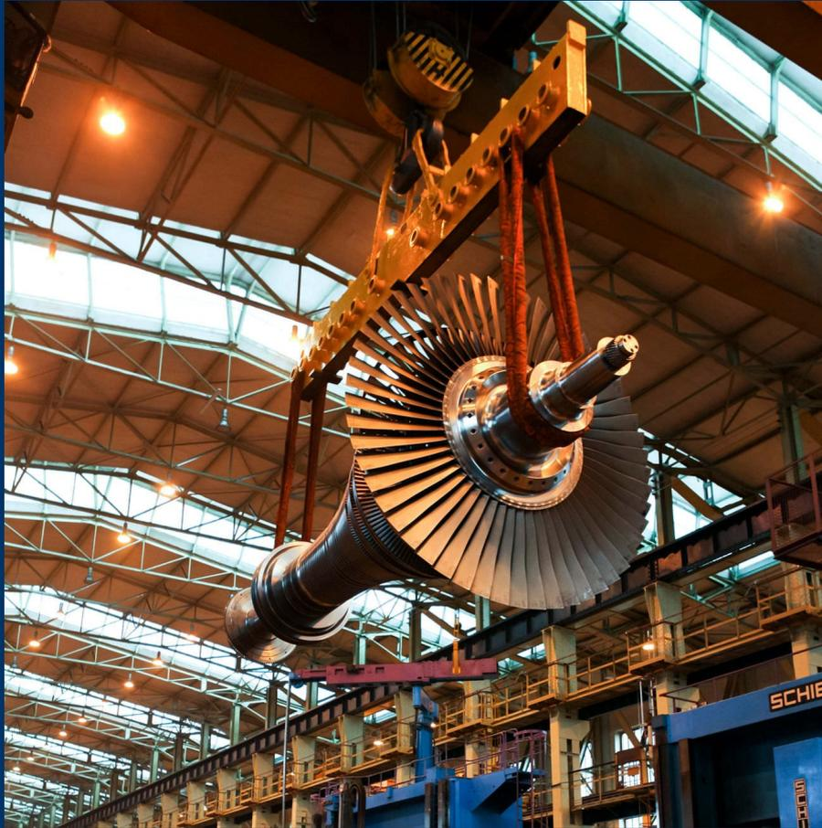
Il vapore sottoposto a pressione mette in moto la turbina, che a sua volta fa girare l'alternatore.
